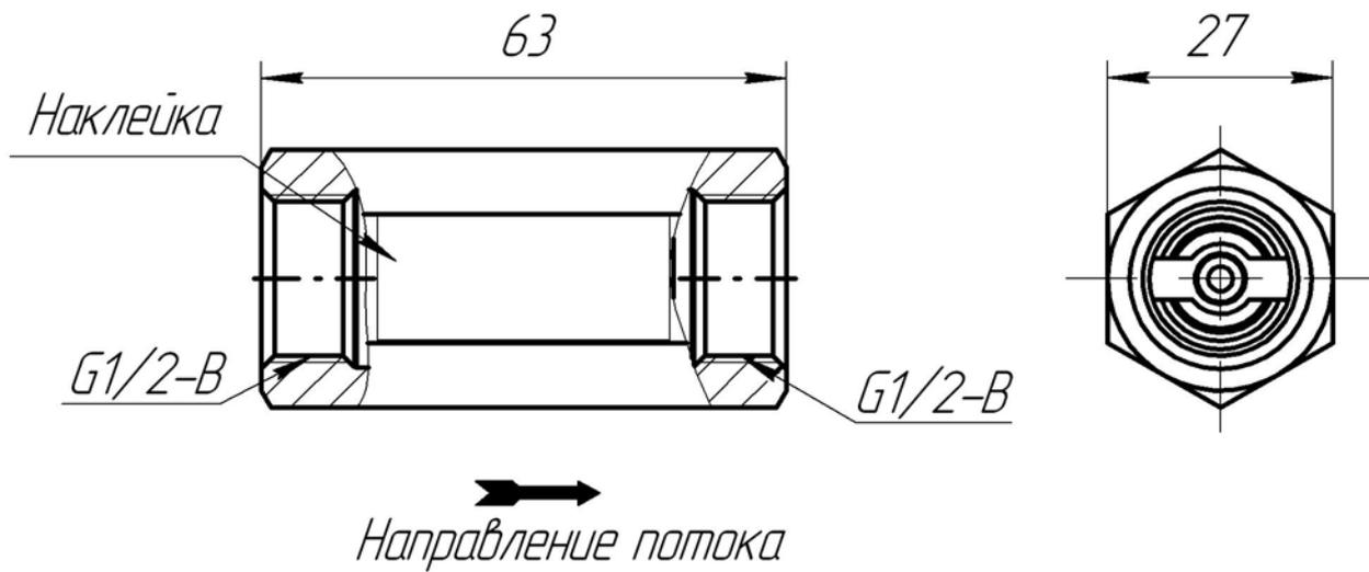
Рисунок 1 – Клапан термозапорный типа DN 15.
